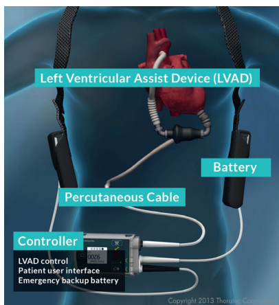
РИС. 2. Внешнее оборудование LVAD. Изображение предоставлено компанией St. Jude Medical
