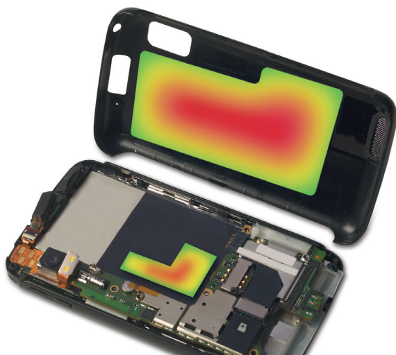
РИС. 5. Гибкие рассеиватели тепла из графитовой фольги обеспечивают рассеивание тепла с электронных компонентов благодаря высокой проводимости в плоскости, в то же время защищая чувствительные к нагреванию области, расположенные ниже, благодаря малой проводимости между плоскостями. Изображение предоставлено GrafTech International
